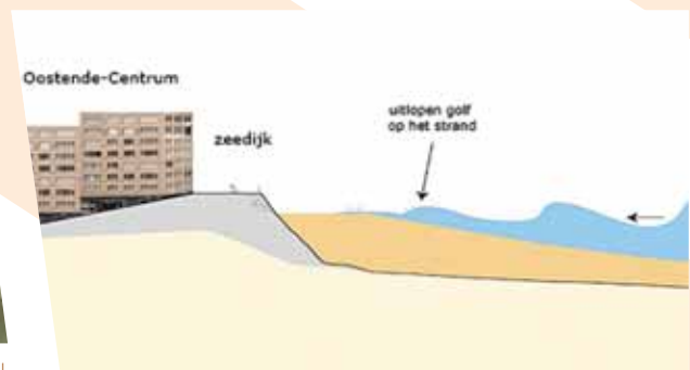
^ De oplossing voor het probleem: de situatie met een zandsuppletie: de golven breken voor ze de zeedijk bereiken, waardoor ze met veel minder kracht de zeedijk bereiken.
