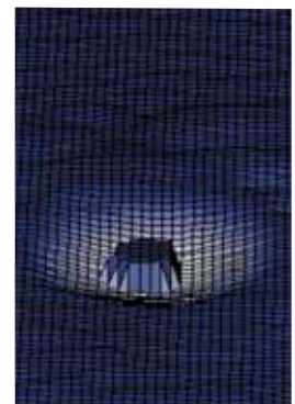
^ Erosieput rond een paalfundering, veroorzaakt door een combinatie van golven en stroming (getijdewerking). Links de foto van een labotest, rechts het overeenstemmende resultaat, bekomen door een 3 dimensionale opmeting van het terrein rond de paal.
