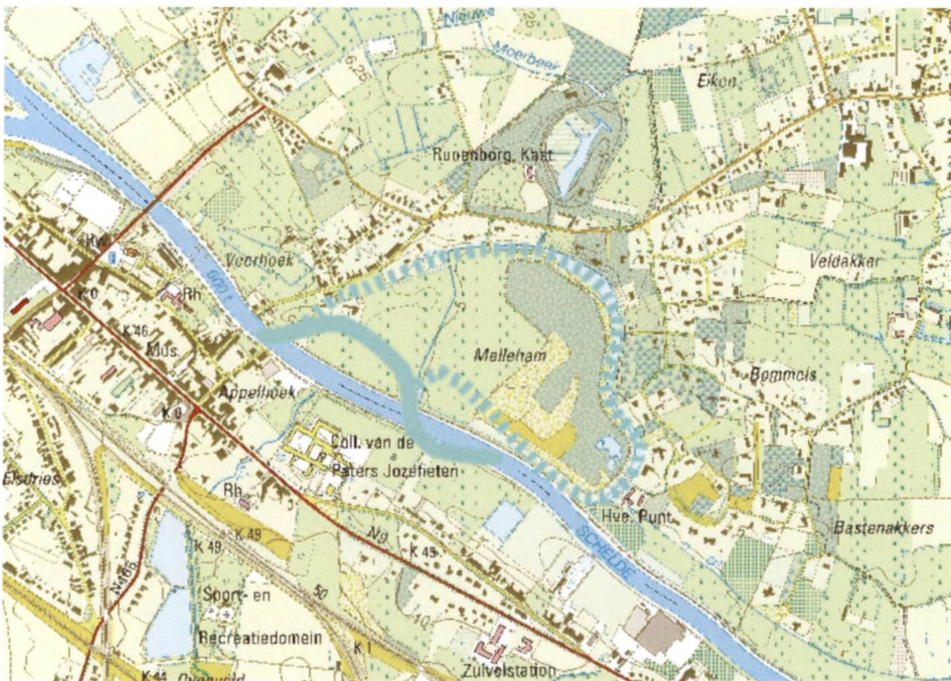
Figuur 3.73 Rechttrekking bij Melleham te Heusden. De stippellijn geeft een meander weer die dateert van vóór 1850.
