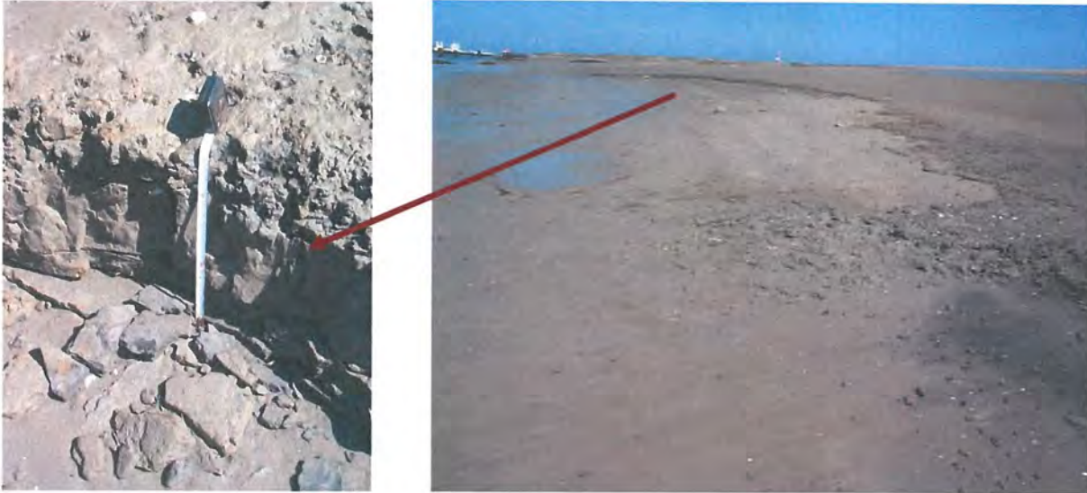
Figuur 7.18 - Erosie van de sliklaag aan de LW lijn met detail (inzet).
