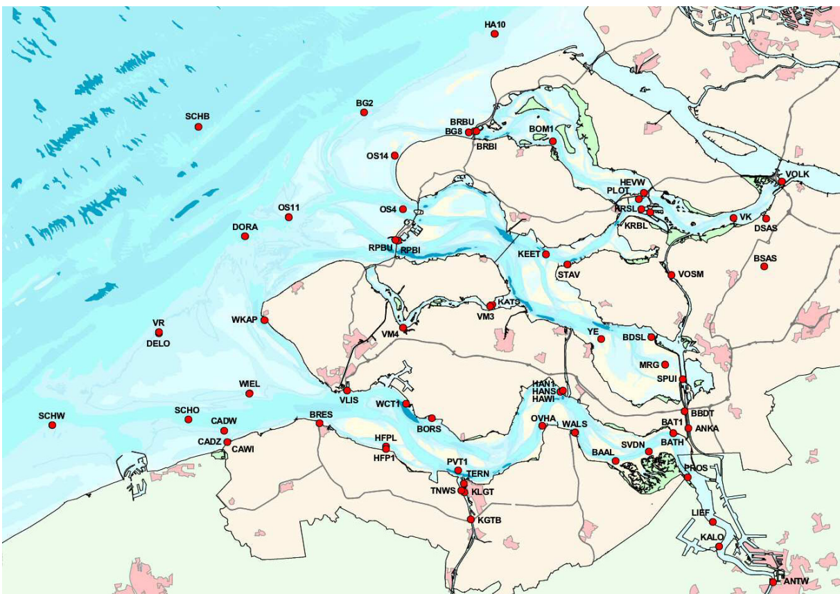
Fig. 4. ZEGE Meetnet. Locatie van de meeteenheden. De meetlocaties SCHW en SCHO zijn Vlaamse meetpunten, Rijkswaterstaat neemt de metingen over van de golfmeetboeien Wandelaar en Scheur/Wielingen van het Meetnet Vlaamse Banken.
