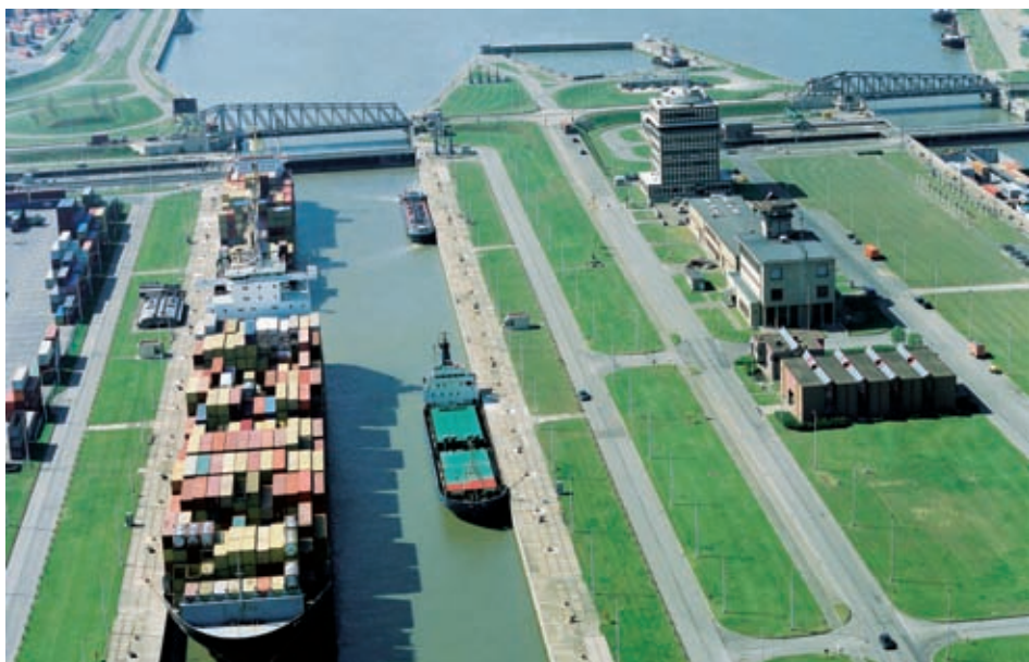
De verkeerscentrale Zandvliet aan de Zandvliet- en Berendrechtsluis begeleidt de grensoverschrijdende zeevaart en de binnenvaart van en naar de haven van Antwerpen. Vanuit Zandvliet coördineert men ook de rampenbestrijding op de Schelde en haar oevers (SVB)
