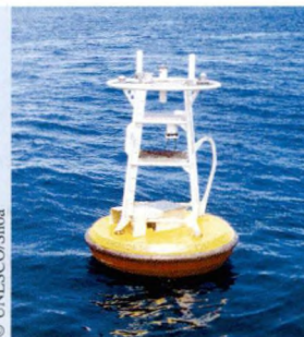
Deze boei ligt voor de kust van Chili en maakt deel uit van het tsoenami waarschuwingssysteem. Ze meet op een diepte van 4.967 meter.
