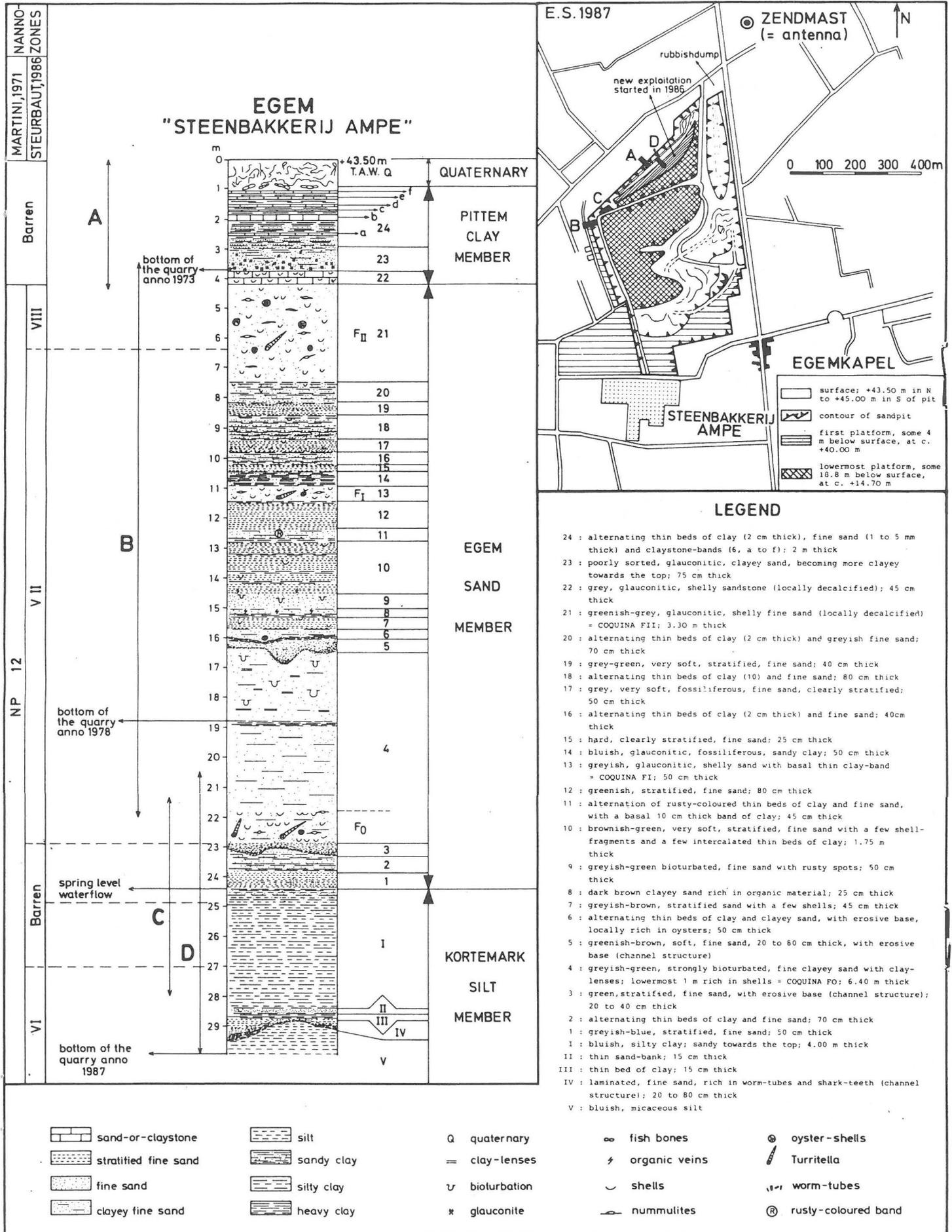
Fig.14. - Stratigraphie des dépôts yprésiens dans l'argilière-sablère Ampe à Egem (d'après STEURBAUT, 1987).
