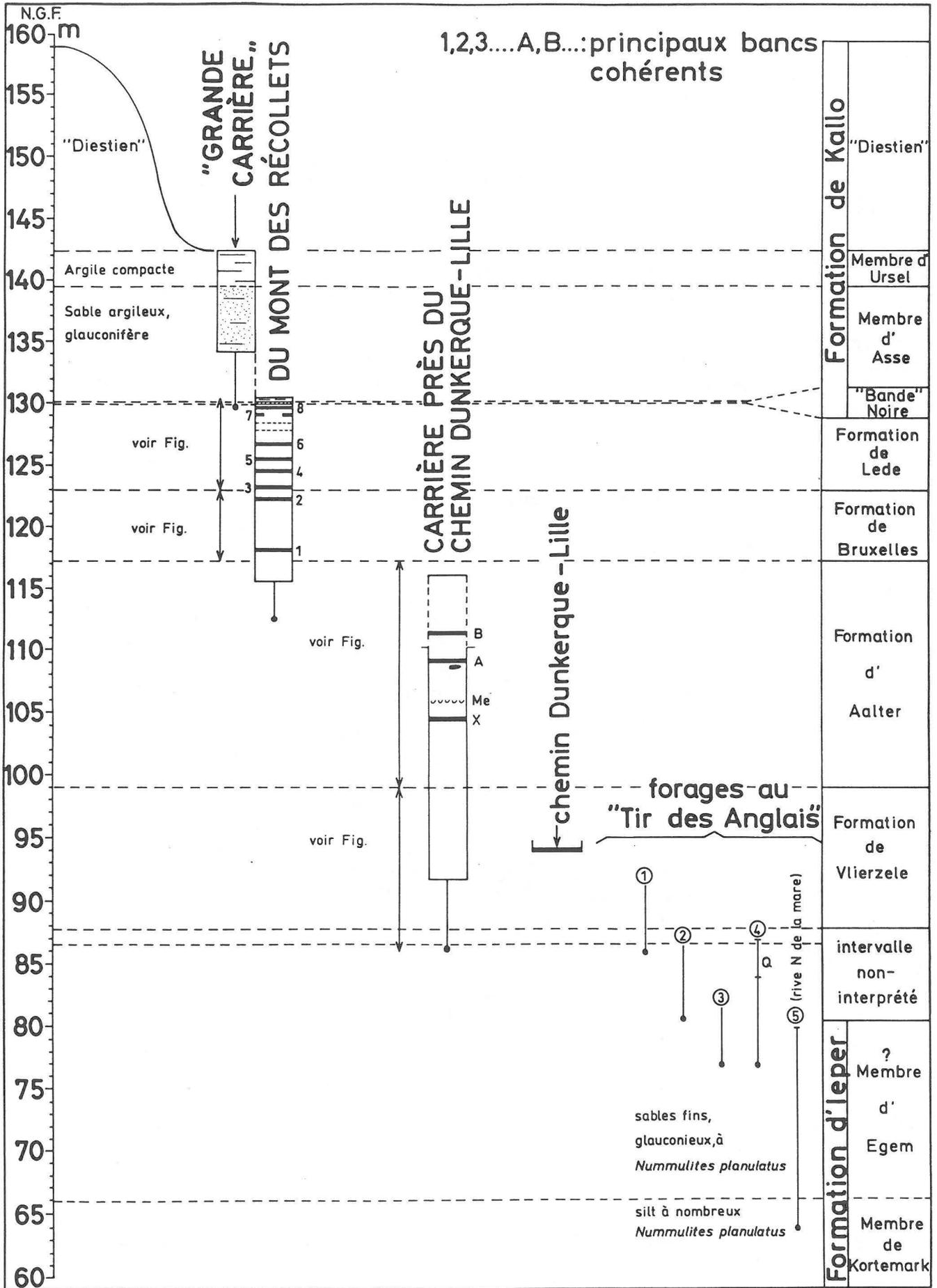
Fig.9. - Position stratigraphique et altimétrique des affleurements du Mont-des-Récollets à Cassel.
