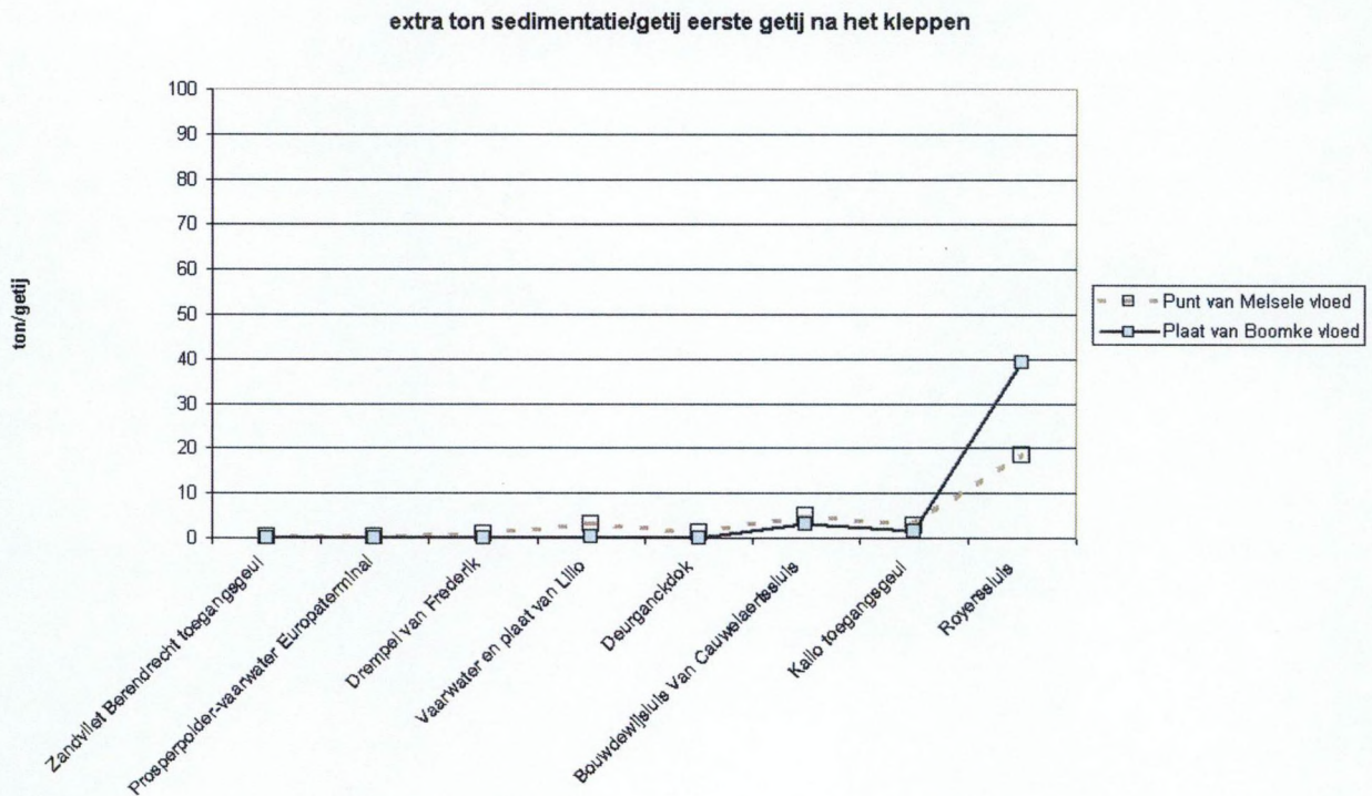
Figuur A- 5 : extra ton sedimentatie/getij gedurende het eerste getij na het kleppen, vergelijking tussen Punt van Melsele en Plaat van Boomke
