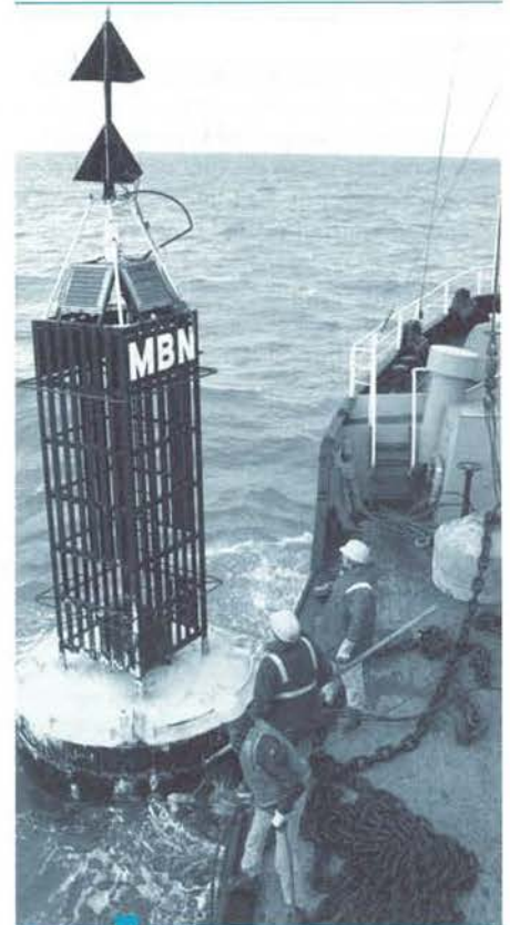
En boei is verankerd met een zware steen (tonsteen) en een ketting. De kettingen - hier te zien op het dek van de boeienlegger 'Zeearend' - zijn van een zwaar kaliber (tot 40 mm diameter). De tonsteen (zie rechts) weegt tussen de 1 en 5 ton
