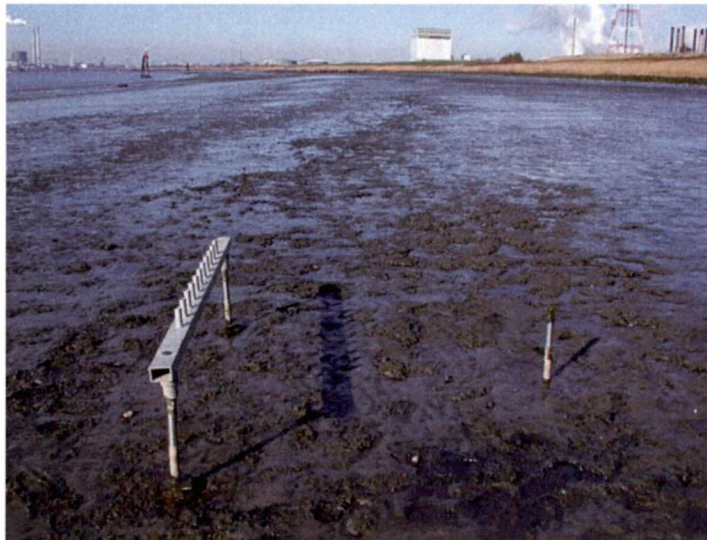
Figuur 4-7: Sederplot voor het opmeten van sedimentatie/erosie (foto Jan Soors).
