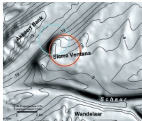
Een digitaal terreinmodel van het baggerstortvak op de Sierra Ventana toont zowel de oude (rode cirkel) als de nieuwe (lichtblauwe cirkel) baggerdumpsite. Momenteel onderzoeken AWZ en de Federale Overheidsdienst Economie, K.M.O., Middenstand en Energie de mogelijkheid om de ca. 50 miljoen ton zand uit het oude baggerstortvak te recupereren en te gebruiken als ophoogzand (RCMG)
