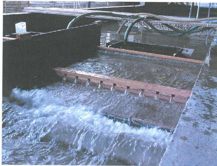
Figuur 3. Proeven in WLH-golfgoot voor ontwerp zeedijkvlooiing te Oostende
