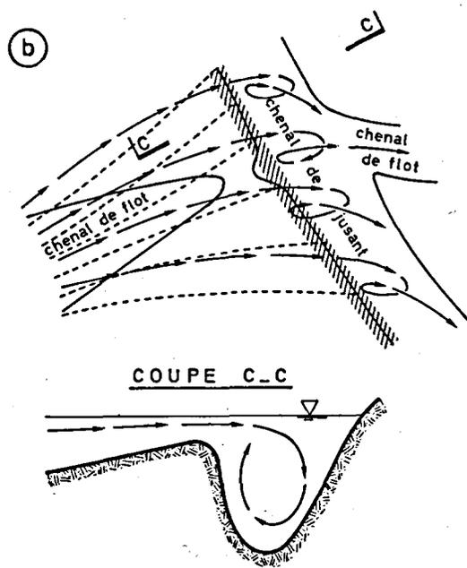
Mouvements d'eau et de sédiments au flot
