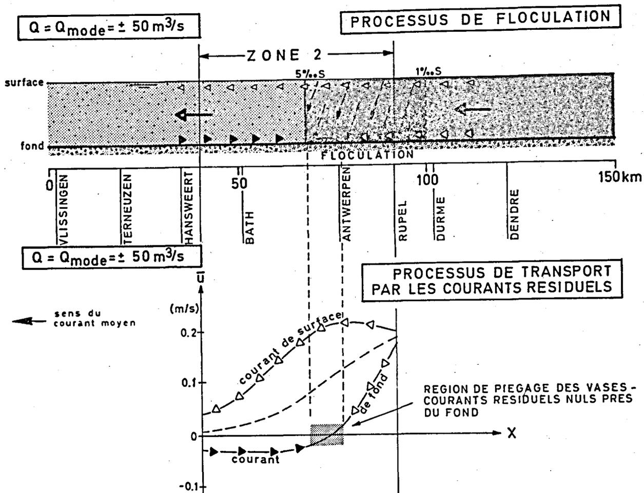
REMARQUES: les vitesses sont moyennées sur un cycle complet de marées et donnent les ordres de grandeur pour des mesures faites le long d'un profil vertical dans le chenal principal. (29 marées)
