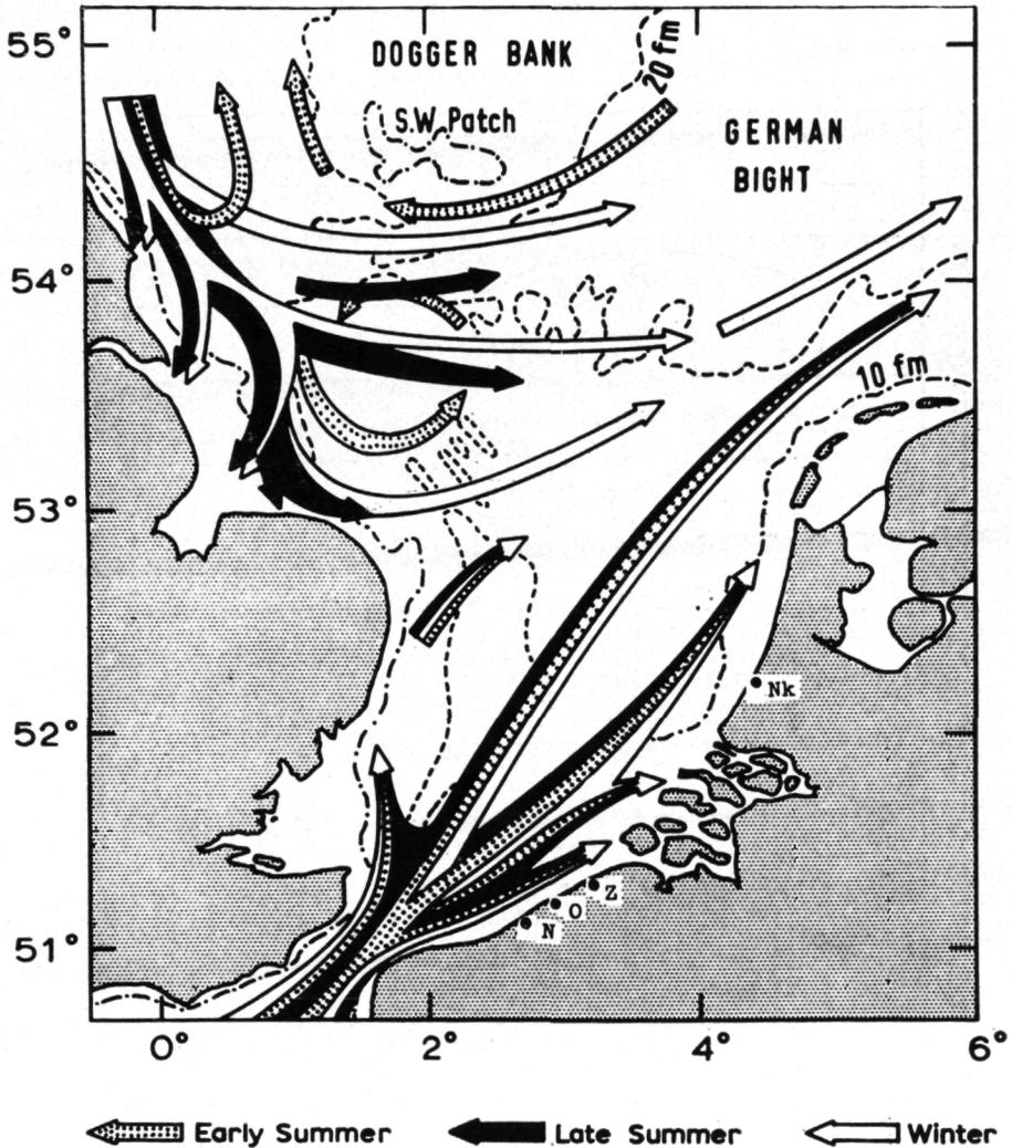
Fig. 4. — Courants de fond généraux (1960-1961) déterminés dans le Sud de la mer du Nord au moyen de « Woodhead Sea-Bed Drifters » (d'après J. RAMSTER, 1965).
