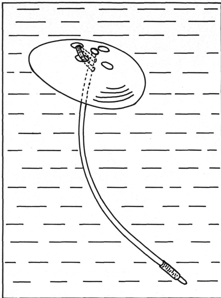
Fig. 3. — Flotteur de fond « Woodhead See-Bed Drifter ».
