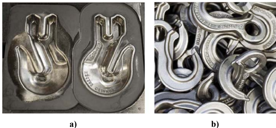
Slika 2.7 a) alat za kovanje kuka za dizalice b) otkovak [55]
