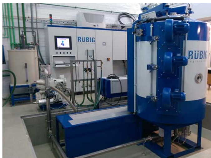
Slika 4.4 Uređaj za plazmatsko nitiranje i prevlačenje Rübiger PC 70/90
