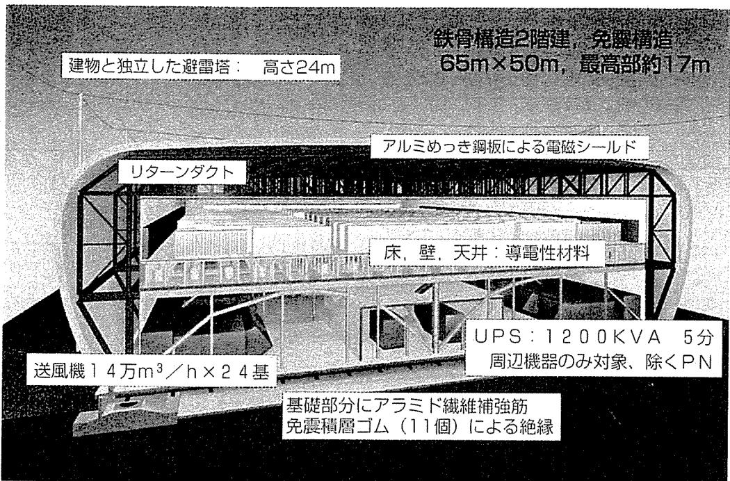
建物全体は、電磁シールド仕様の鋼板でできているが、さらにコンピュータが設置される二階のフロア全体、INのケーブルが敷かれているフリー・アクセス床内と三重のシールド構造となっている。トータルなシールドの性能は50dBである。
