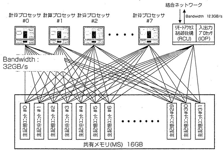
スーパーコンピュータでは、多くのアプリケーションがメモリの広いアドレス空間に対してアクセスを行うが、特に多いのは、配列データのように規則的に並んだデータである。ベクトルプロセッサの 8 GFlops という高い性能を如何なく発揮させるためには、メモリとのデータのやりとりが途切れないようにスムーズに行われなければならない。
