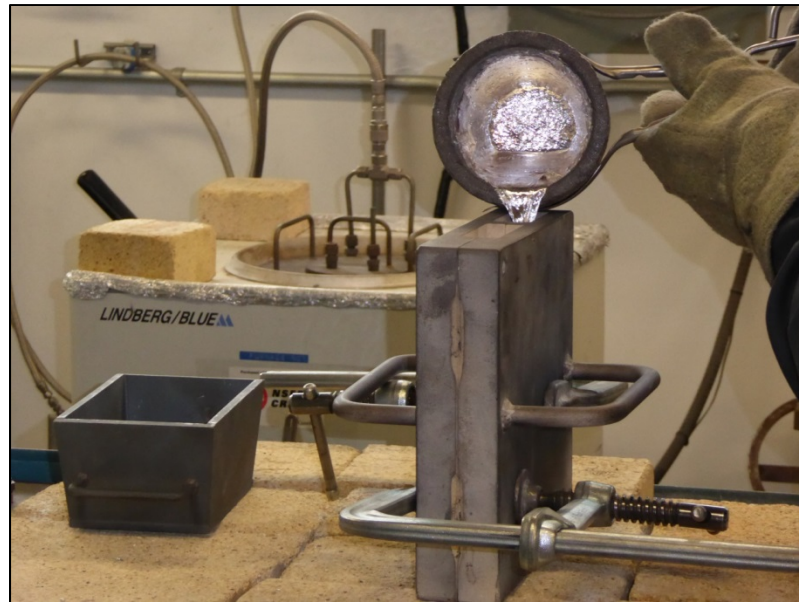
Figure 2.5 Coulée de l'alliage
