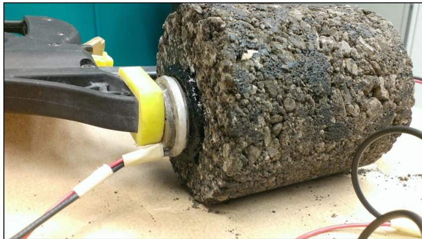
Figure 3.13 Test avec mastic bitumineux
