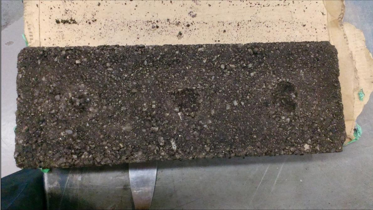
Figure 4.7 Dessous de la plaque 2. On remarque les 3 emplacements des portes transducteurs, là où de la matière manque
