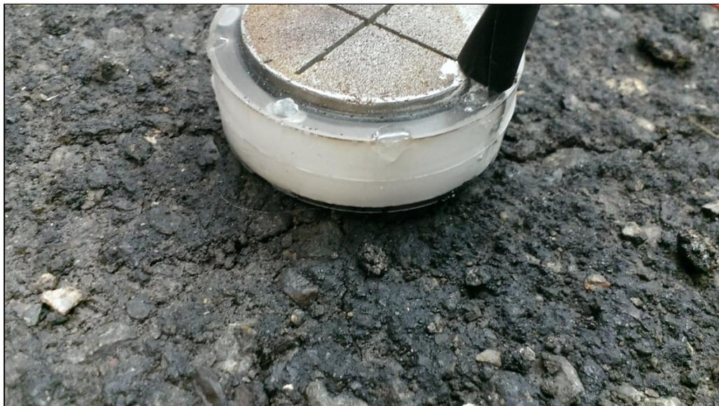
Figure 4.1 Transducteur 51-45 supérieur, présence de fissures
