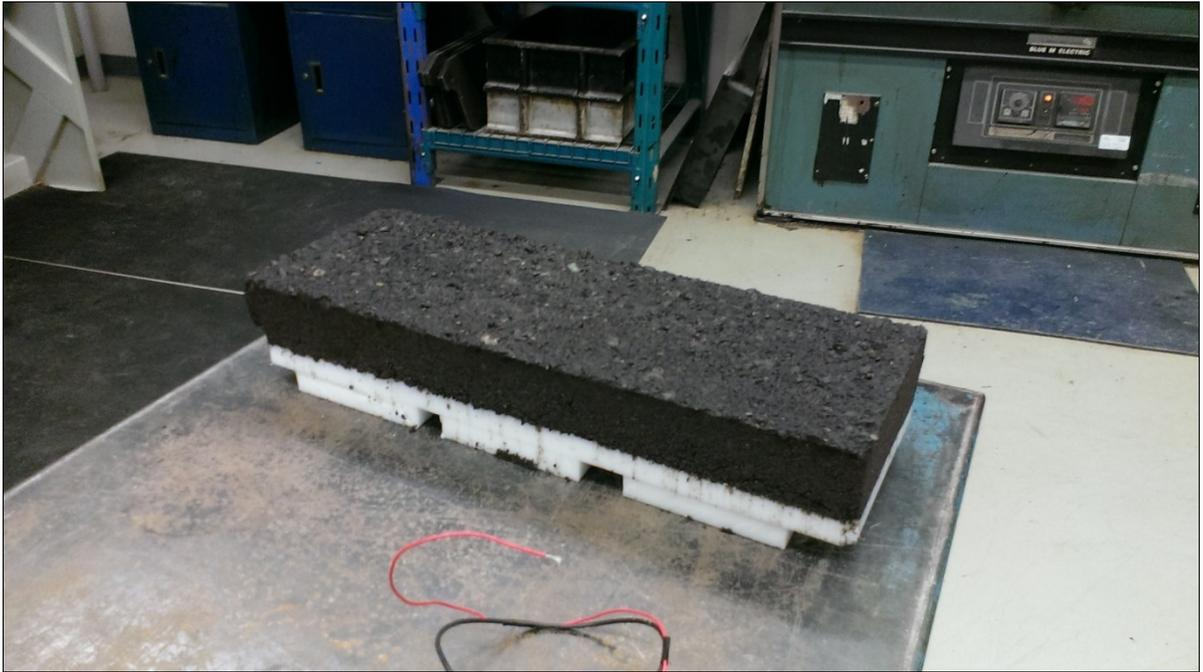
Figure 2.5 Plaque d'EB après compaction et sortie du moule
