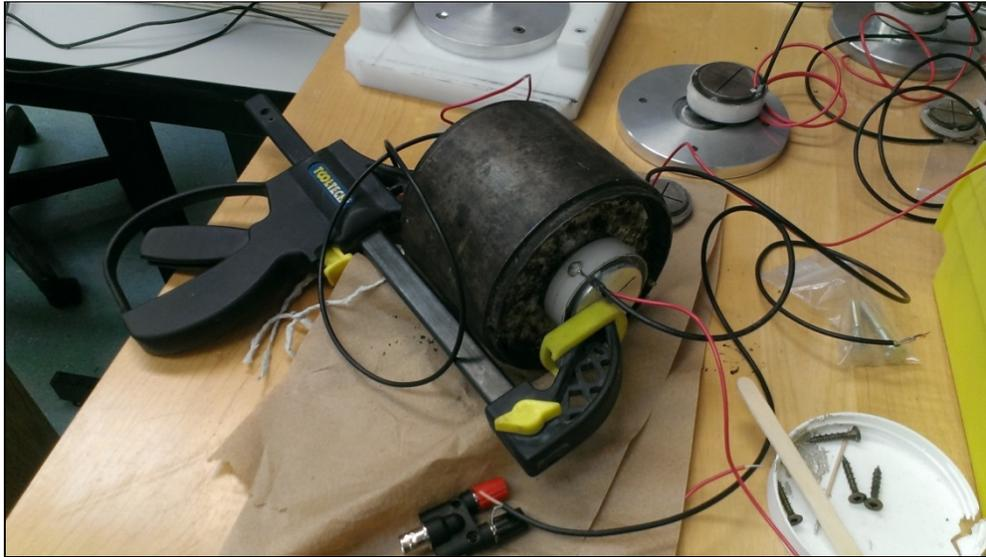
Figure 2.1 Échantillon de 63 mm obtenu à la presse Marshall
