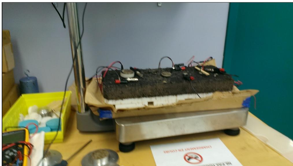
Figure 2.12 Plaque sur la balance pour mesurer la masse
