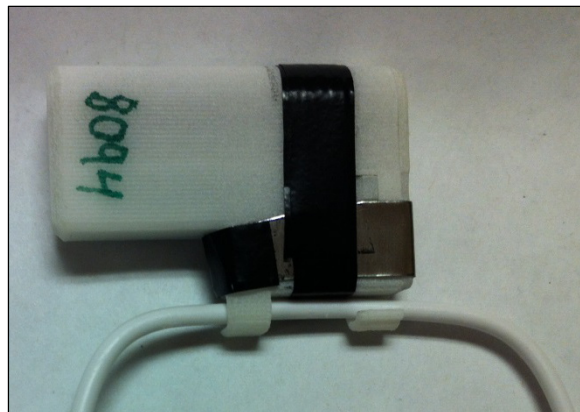
Figure 1.6 Le capteur de courant dans son boîtier
