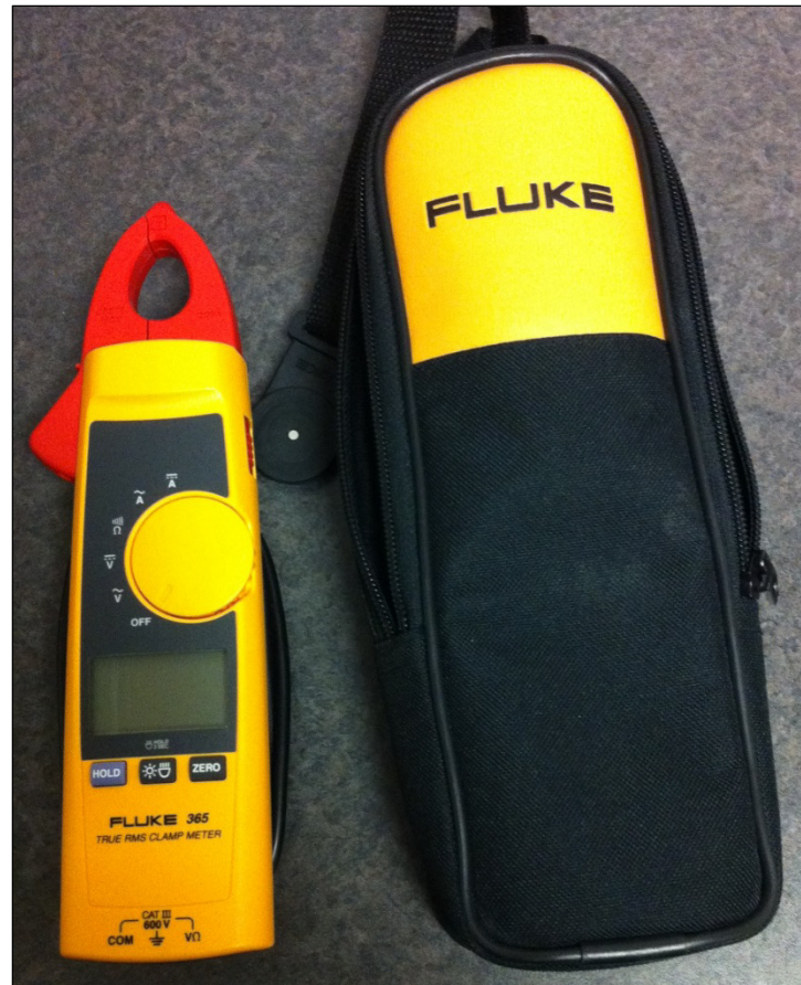
Figure 5.4 Pince multimètre TRMS AC Fluke 365
