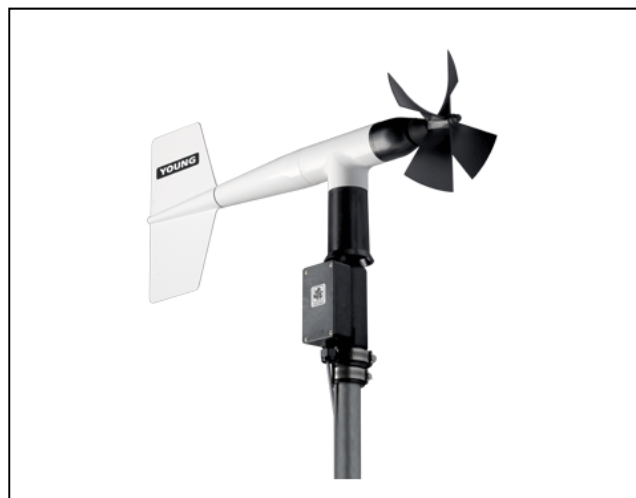
Figure A III-3 Capteur de vitesse et direction du vent RMY05103 tirée de(R. M. Young, 2008)
