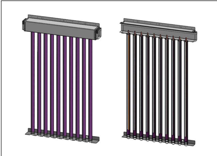
Figure 3.5 Vue en coupe du collecteur solaire à caloducs
