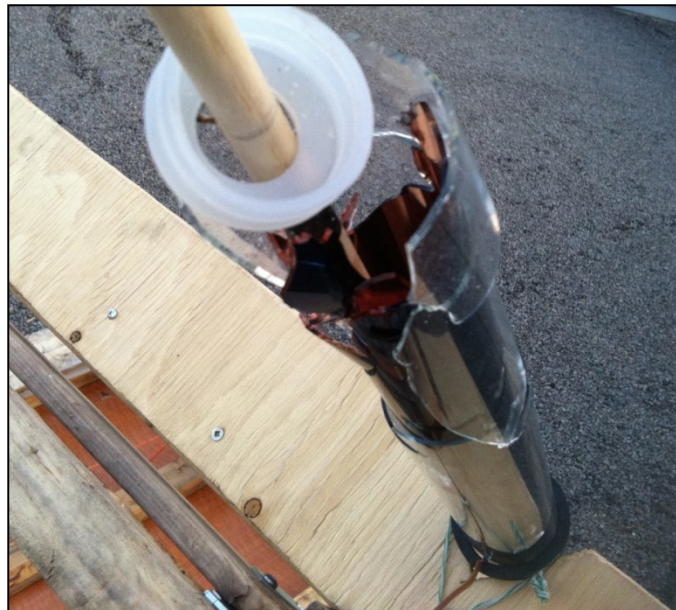
Figure 4.9 Résultats du test de stagnation d'un tube ouvert aux deux extrémités
