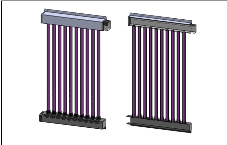
Figure 3.3 Vue globale (gauche) et vue en coupe (droite) du collecteur solaire à tubes ouverts aux deux extrémités
