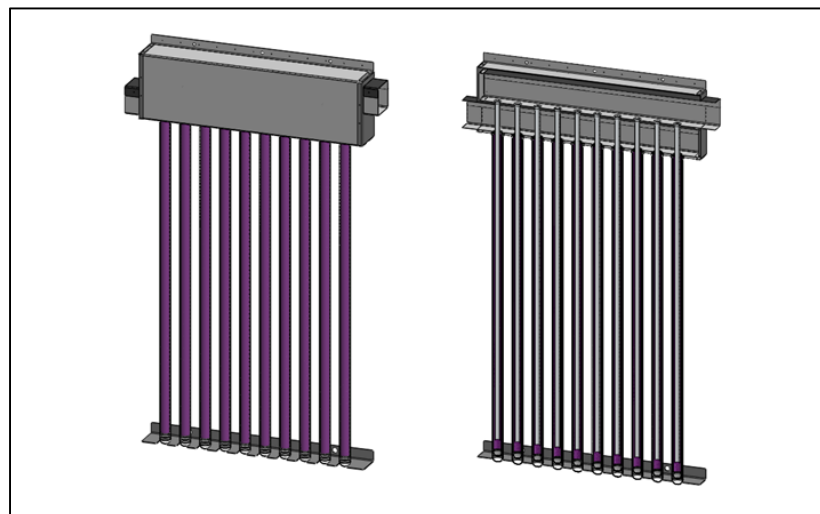
Figure 3.1 Vue globale (gauche) et vue en coupe (droite) du collecteur solaire classique à tubes de Sydney
