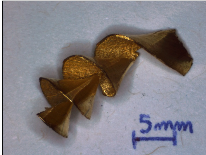
Figure 3.36 Copeau obtenu à V_c=50\text{m/min} et f=0.22\text{mm/tr} - OS250
