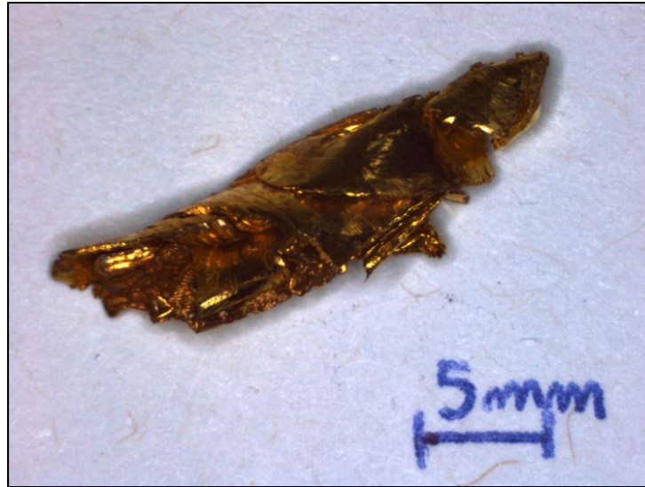
Figure 3.38 Copeau fondu et dézincifié obtenu à V_c=300\text{m/min} et f=0.22\text{mm/tr} - OS250
