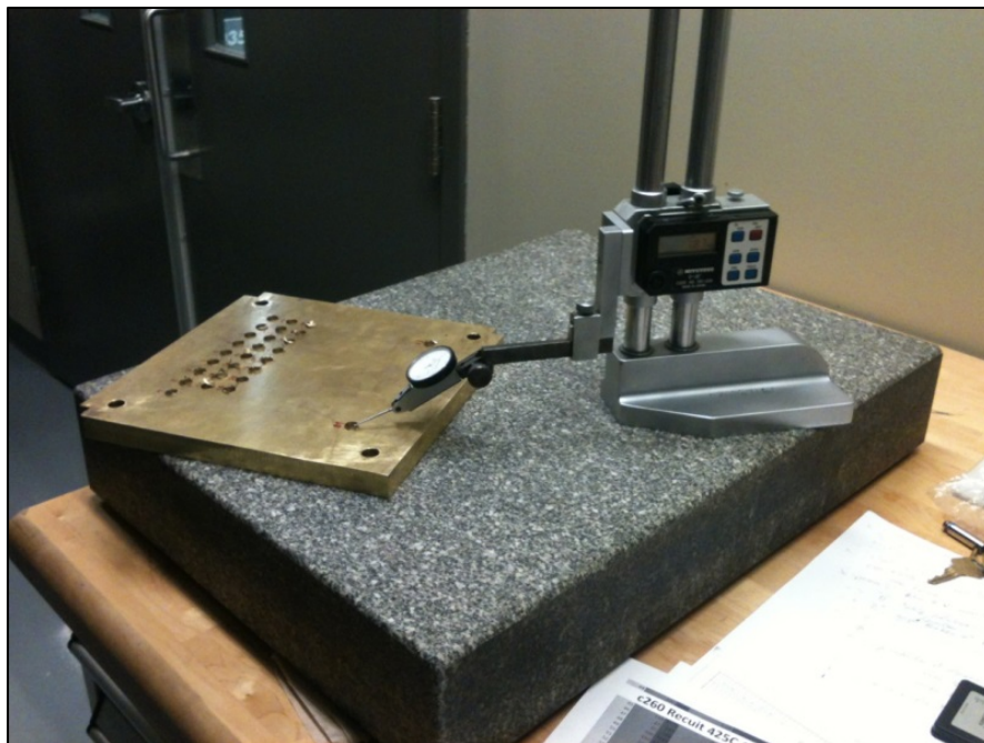
Figure 2.12 Montage pour les mesures des bavures
