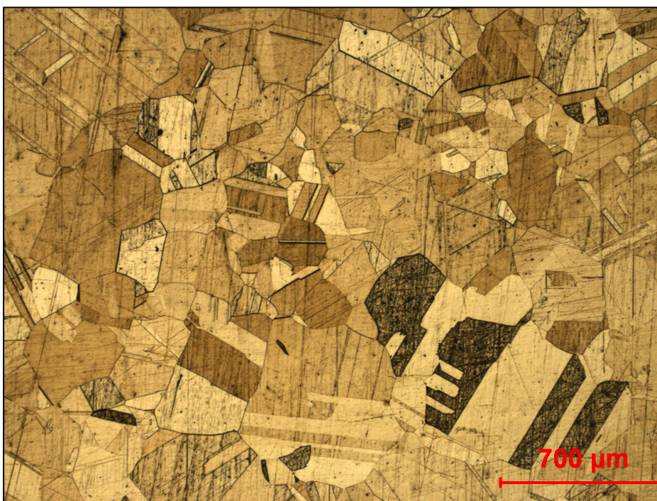
Figure 2.4 Micrographie après recuit à 700°C/1h
