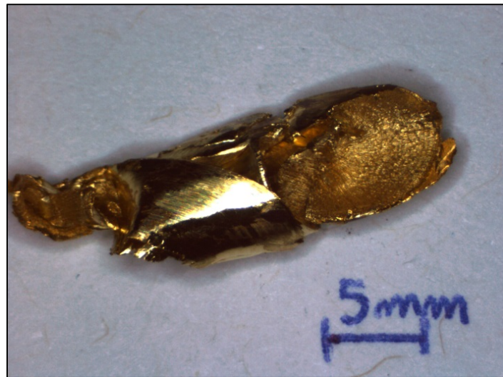
Figure 3.37 Copeau fondu obtenu à V_c=150\text{m/min} et f=0.22\text{mm/tr} - OS250
