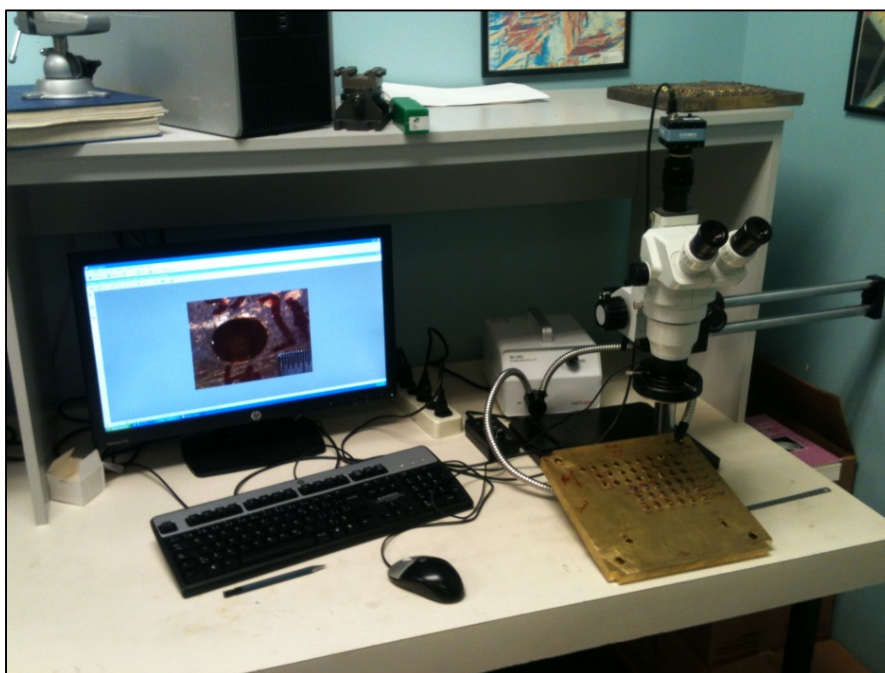
Figure 2.13 Montage pour identification du type de bavure
