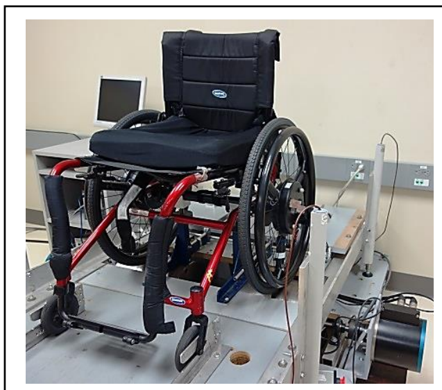
Figure 0.1 Simulateur de propulsion avec rétroaction haptique
