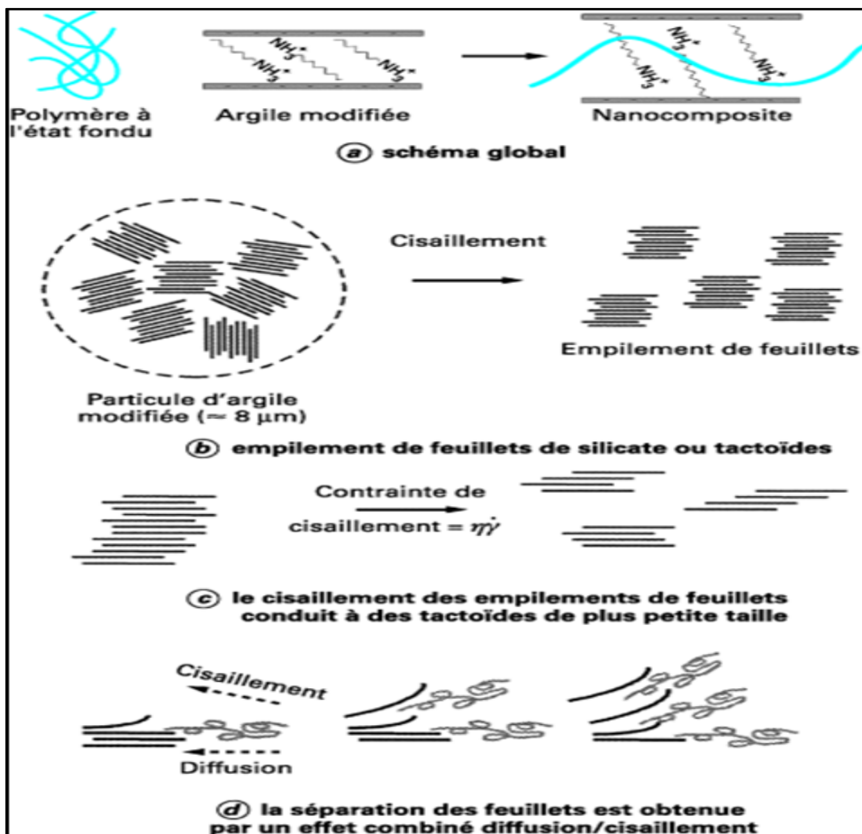
Figure 1.12 Schéma de l'élaboration de nanocomposites par mélange à l'état fondu
