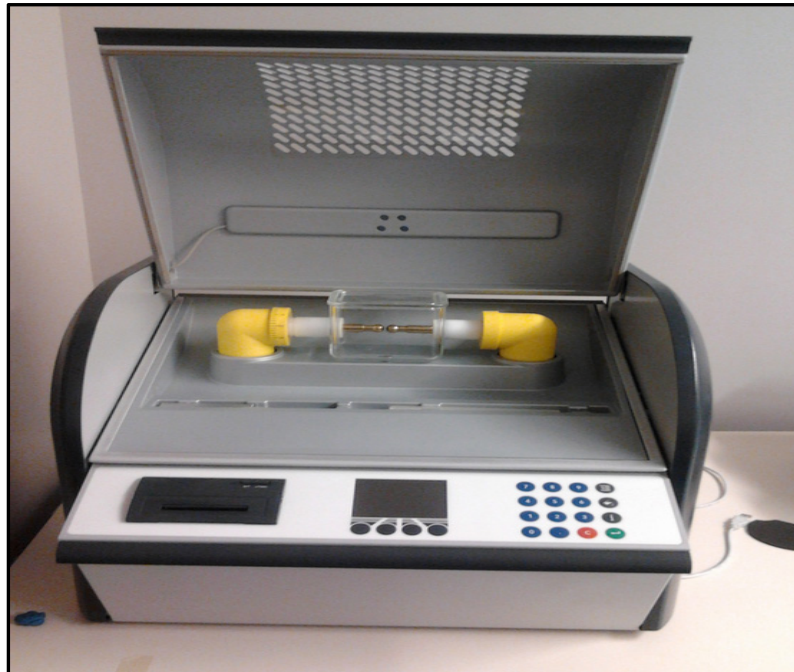
Figure 2.6 Testeur d'huile utilisé pour une mesure de rigidité diélectrique
