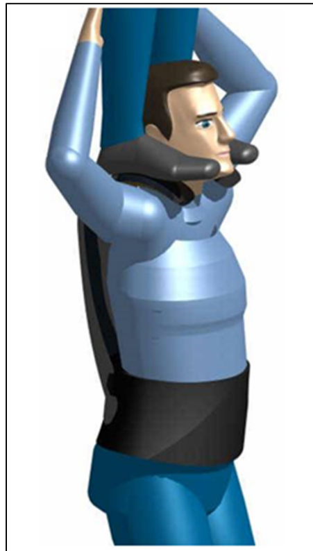
Figure 4.2 Concept préliminaire de dispositif de protection pour porteur de colonne humaine
