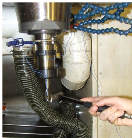
Figure 23 -Montage utilisé pour le sonnage de la broche. E 3.2 -Matériel utilisé.
