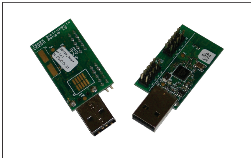
Figure 4.1 Photo des modules CC2511EMK de Texas Instruments utilisés.
