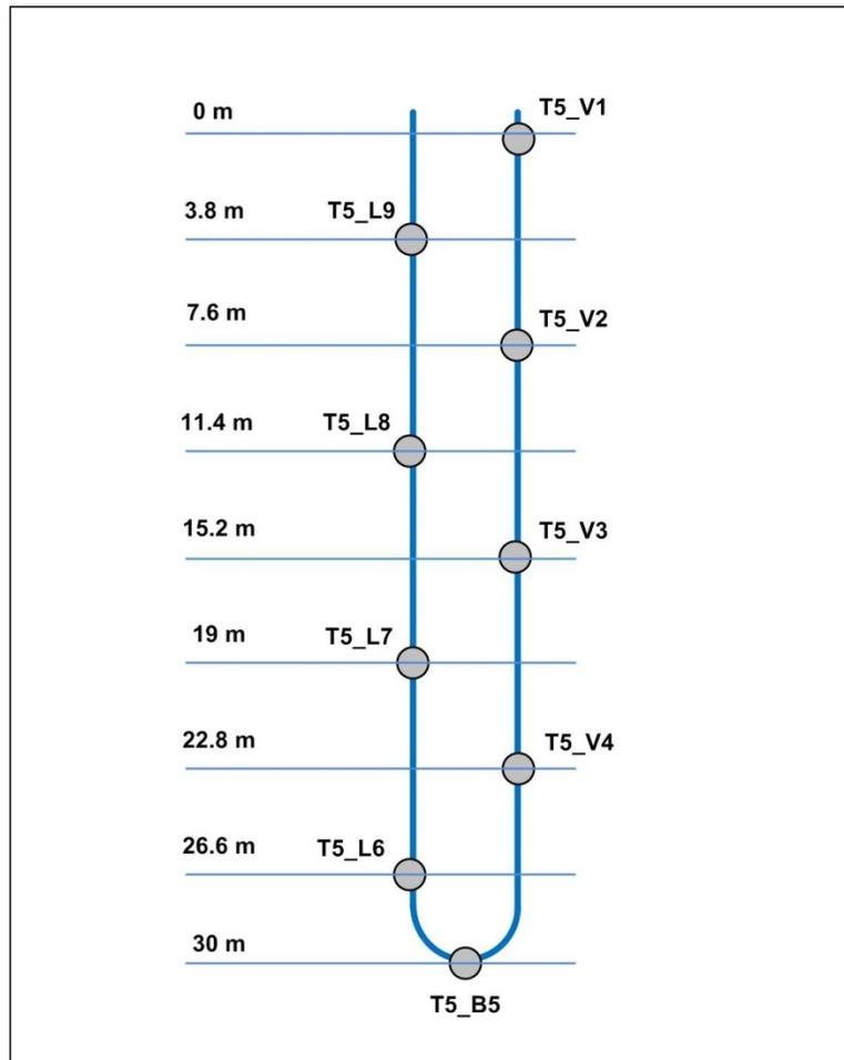
Figure 3.4 Positionnement des thermocouples dans le puits.
