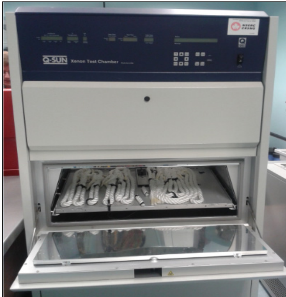
Figure 2.4 : Chambre climatique pour exécuter le vieillissement
