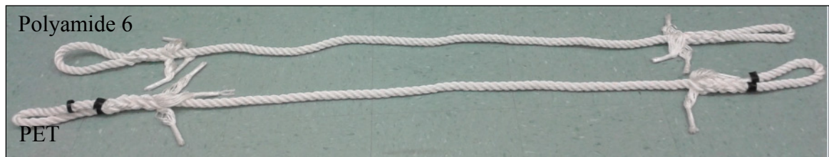
Figure 2.1 : Corde de polyamide 6 et de PET
