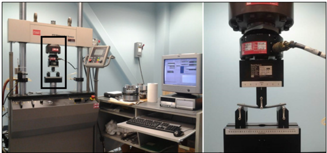
Figure 2.12 Montage de flexion trois points
