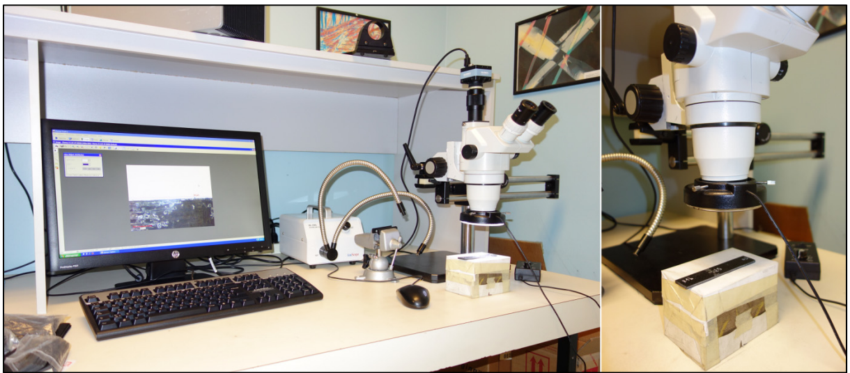
Figure 2.28 Montage pour les mesures de délaminage
