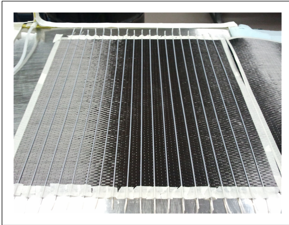
Figure-A I.2 Installation des fils sacrificiels
