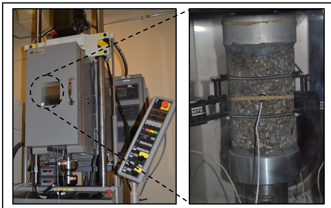
Figure 3.21 Presse hydraulique utilisée pour les essais thermomécaniques avec une éprouvette mise en place lors d'un essai de module complexe
