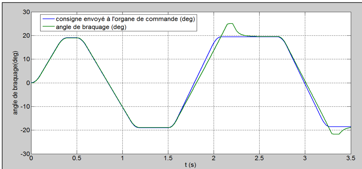
Figure 3.21 Suivi de consigne d'angle réalisé par l'EHA.
