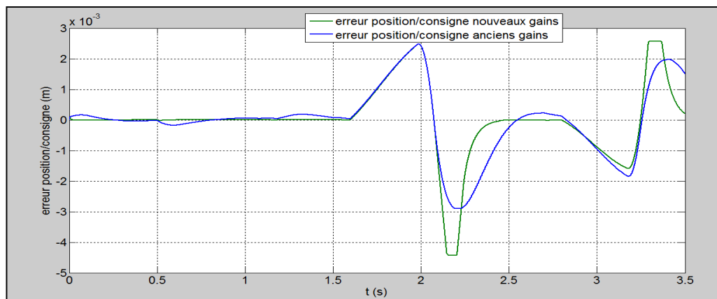
Figure 3.11 Comparaison des différentes erreurs de position pour les différentes valeurs de gains du correcteur.
