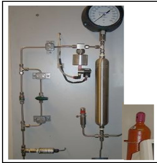
Figure 2.6 Système de pressurisation
