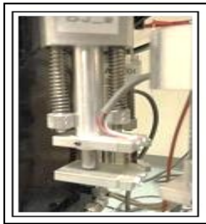
Figure 2.3 Montage des LVDT
