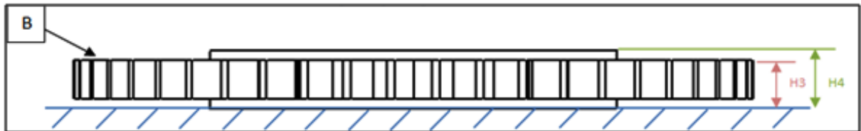
Figure A II-6 Mesure des épaisseurs face B
