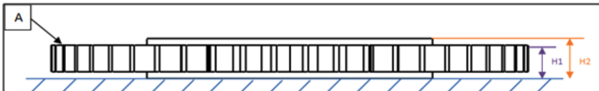
Figure A II-4 Mesure des épaisseurs face A roue « 1280 »
