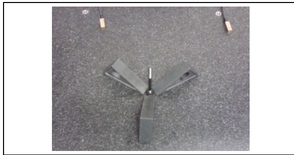
Figure A II-7 Mise en position et bridage du support « 1280 » sur le marbre : étape 1
