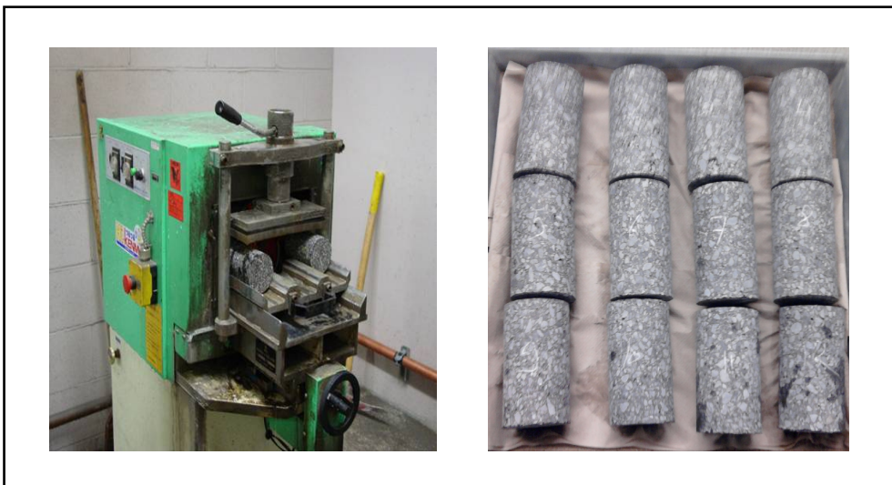
Figure 4.6 Resurfaceuse et éprouvettes obtenues
