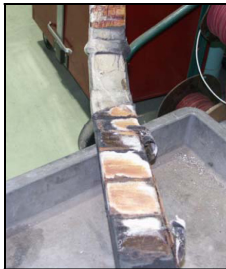
Figure 1.4 Une barre soumise à des DP d'encoche avec de la vibration mécanique
