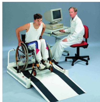
(a) VP100. Ergomètre à rouleaux communs (rouleaux communs aux deux roues arrière) offrant une résistance de roulement et une inertie. Décrit dans Devillard et al. (2001), il est commercialisé en tant qu'appareil d'entraînement. Schéma tiré de Devillard et al. (2001) et reproduit avec l'autorisation de Springer. Photographie tirée de Médical-Développement (2004b) et reproduite avec l'autorisation de Médical Développement, HEF-DURFERRIT.
