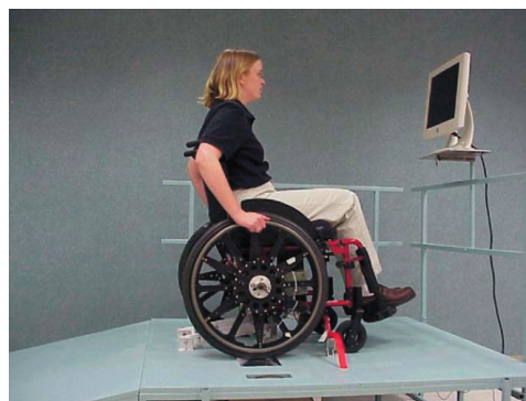
(c) Ergomètre de la clinique Mayo. Ergomètre à rouleaux indépendants offrant une résistance de roulement et une inertie. Décrit dans Kotajarvi et al. (2006), il a été utilisé pour fournir un biofeedback visuel sur la MEF moyenne sur un cycle de propulsion. Figure tirée de Kotajarvi et al. (2006) et reproduite avec l'autorisation de Elsevier.
