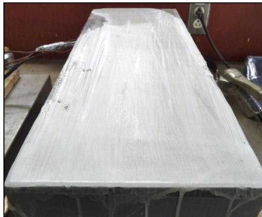
Figure-A II-2 Éprouvette scellée dans la paraffine
