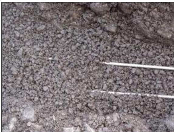
Figure 3.8 Recouvrement de la sonde avec le matériau de confinement (fraction 0/5 de MR5-TFE)
