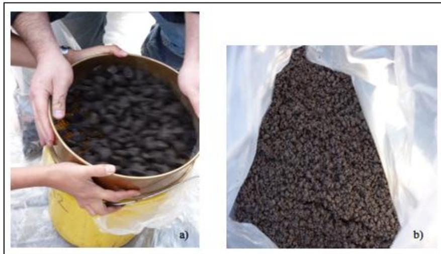
Figure 3.3 a) Tamisage du matériau MR5-TFE en chantier;
