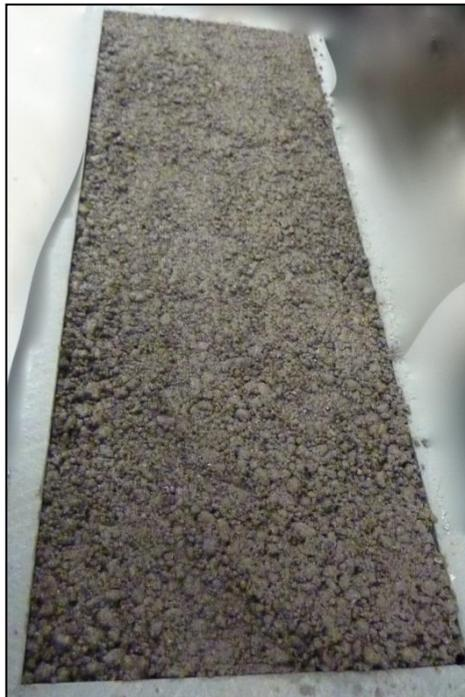
Figure-A I-4 Dernière couche de l'éprouvette compactée
