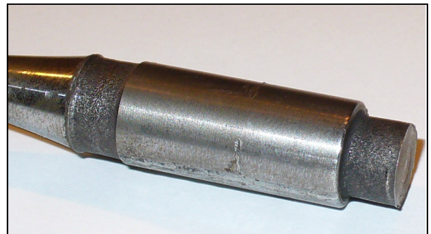
Figure 6.7 Éprouvette usée après 3 millions de cycles
