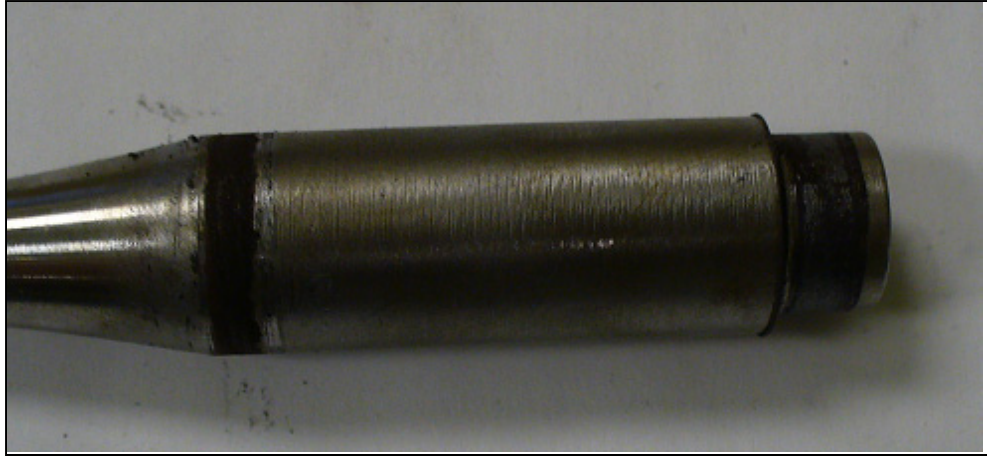
Figure 6.12 Éprouvette usée, acier 1018 après 70000 cycles
