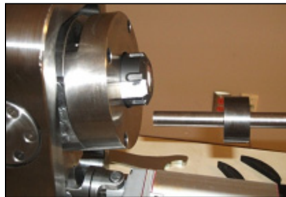
Figure 6.19 Éprouvette brisée à la base du moteur
