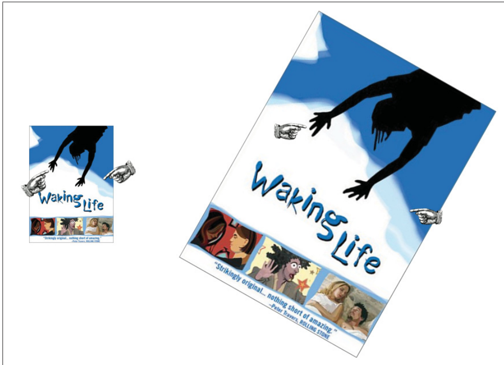
Figure 1.6 La manipulation directe, avec deux points d'entrée, permet de faire une translation, rotation, et changement d'échelle simultanément. Les deux points d'entrée peuvent être fournis par deux doigts, deux souris, ou deux autres dispositifs de pointage.
