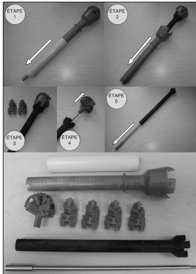
Figure 4.6 Étapes de désassemblage de la partie inférieure
