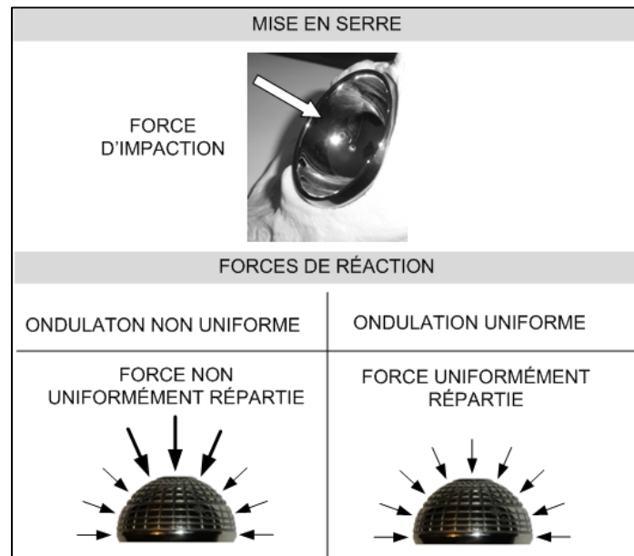
Figure 4.49 Répartition des forces de réaction plausible selon le type d'ondulation
