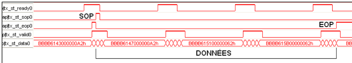
Figure 7.6 Requête d'écriture dans la mémoire principale
