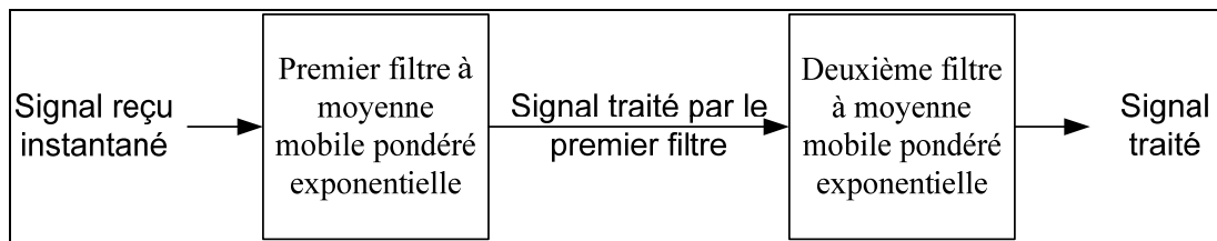
Figure 3.6 Diagramme bloc du bloc de traitement en utilisant deux filtres à moyenne mobile pondéré cascades
