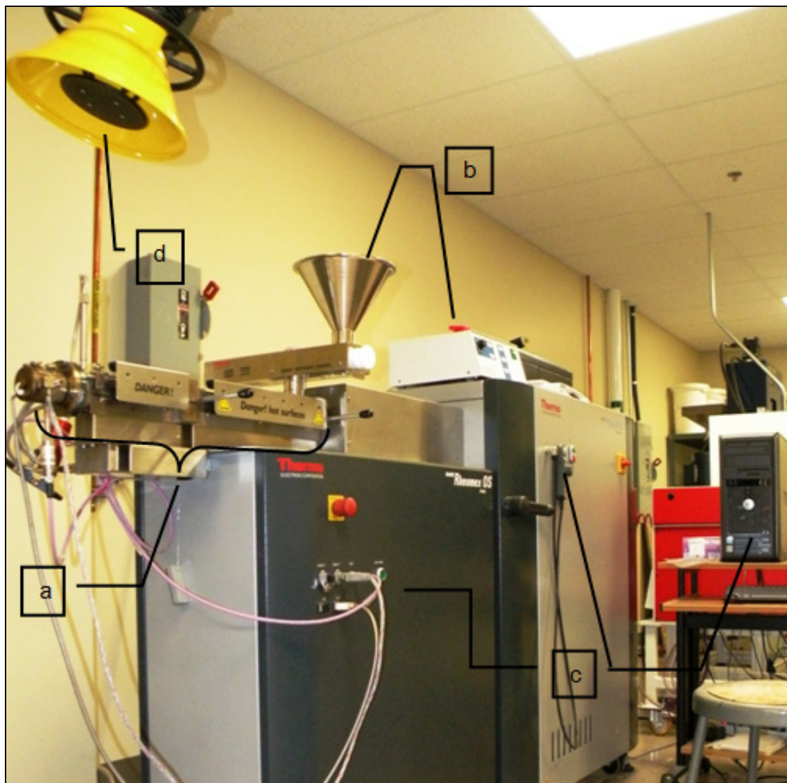
Figure 2.4 Photo représentant les installations de production a) extrudeur à double vis co-rotatives, b) dévidoir externe à contrôle variable, c) Système de contrôle
