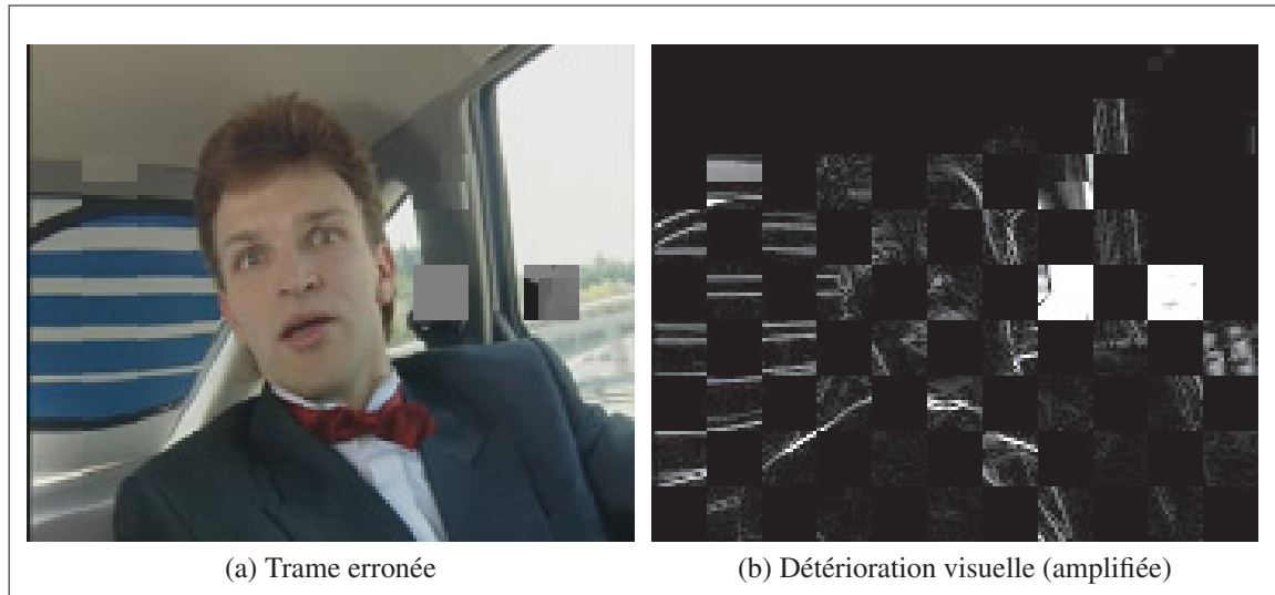
Figure 2.5 Exemple de la détérioration visuelle issue du décodage d'une tranche corrompue contenue dans une trame avec un ordonnancement de type dispersé.
