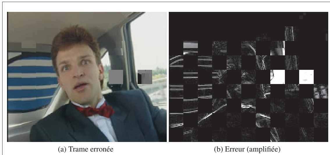
Figure 6.4 Exemple de l'erreur présente dans la sous-séquence #1752 du jeu de tests. (Séquence : Carphone, QP=16 BER=0.0032, FMO=Dispersé)
