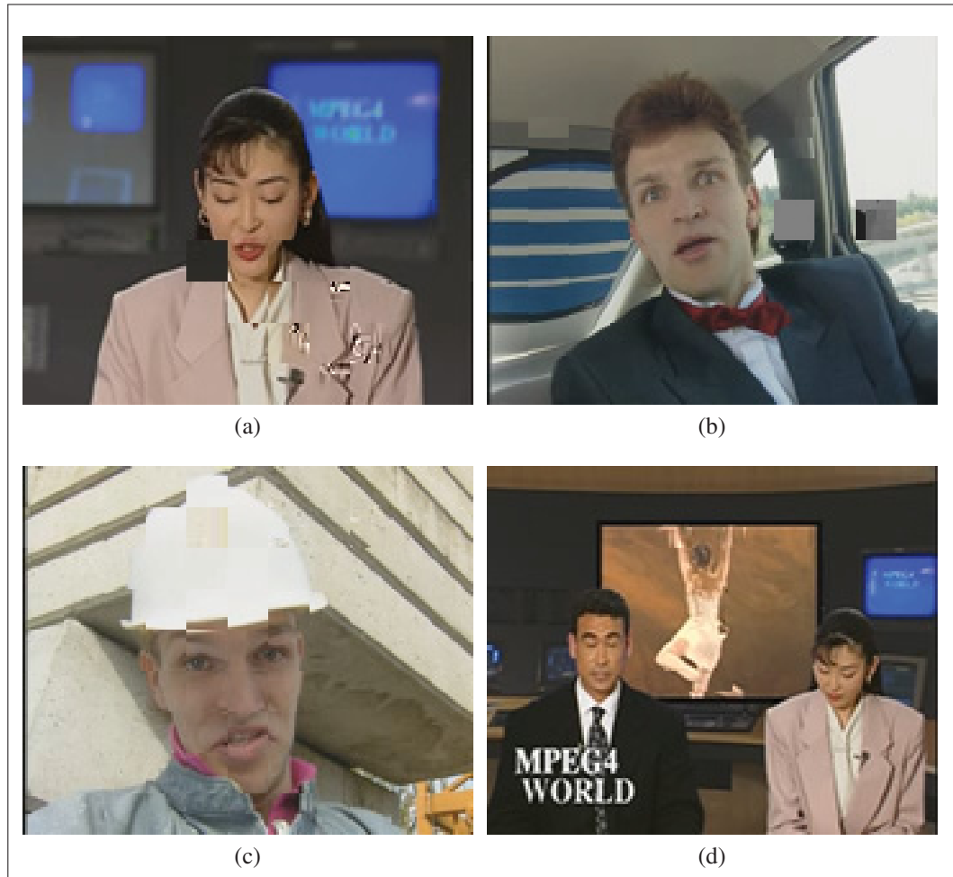
Figure 3.2 Exemples de la détérioration visuelle issue du décodage désynchronisé de paquets corrompus.
