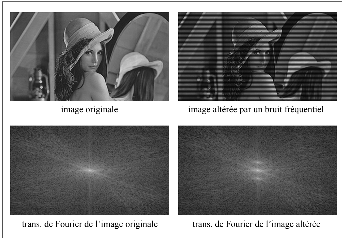
Figure 1.9 Magnitude de la transformée de Fourier. Image originale adaptée de Gonzalez et Woods (2008)
