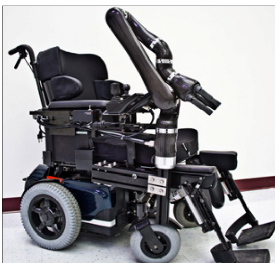
Figure 1.2 Le bras manipulateur JACO.
