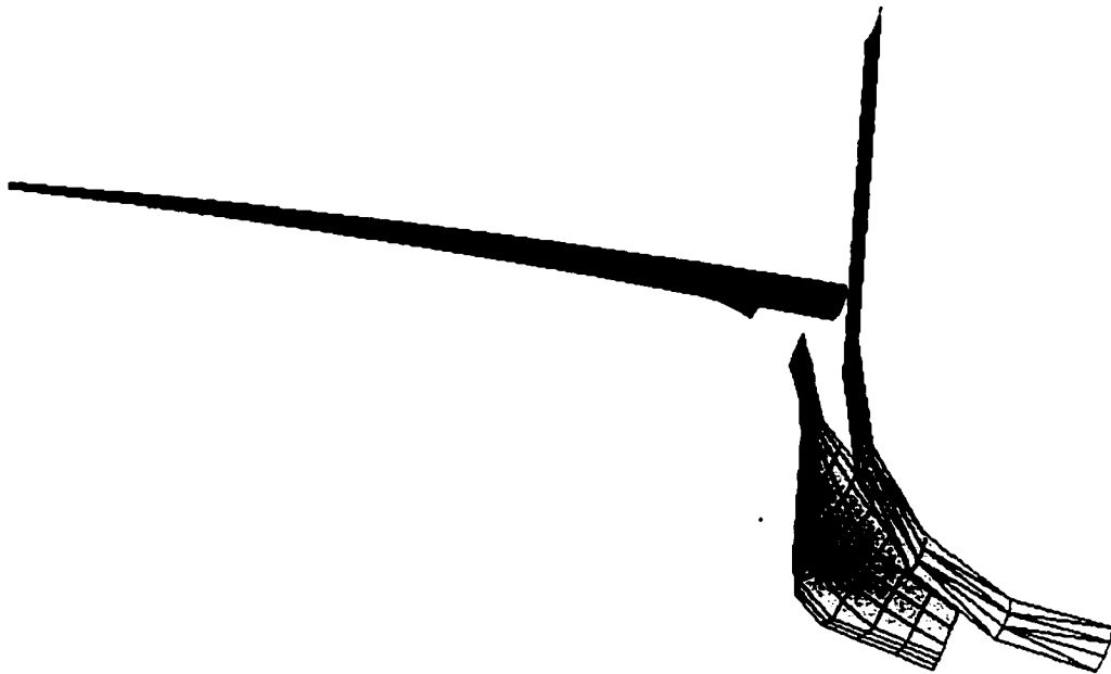
Figure 4.23 Surfaces de contact de la capsule appairées avec le plongeur et la gorge de sertissage
