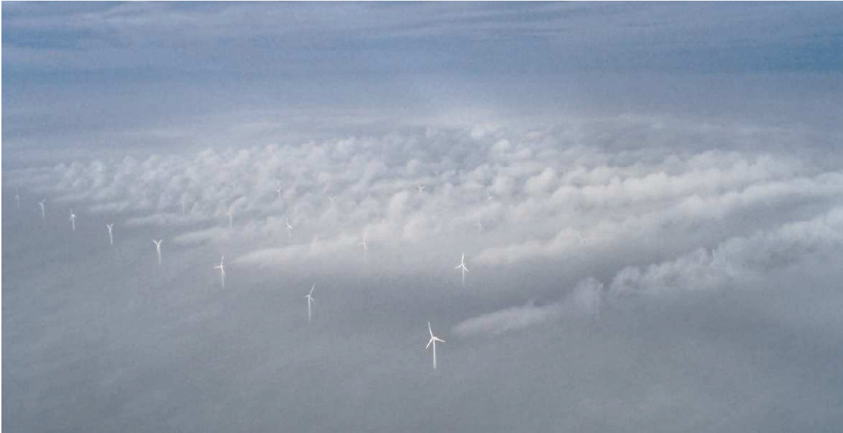
Figure 2.3 Rotation du sillage d'éoliennes. Adapté de Ivanell (2009)
