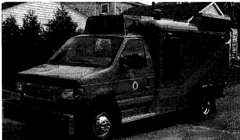
Figure 23 Analyseur de routes automatique ARAN (Automatic Road Analyser)
